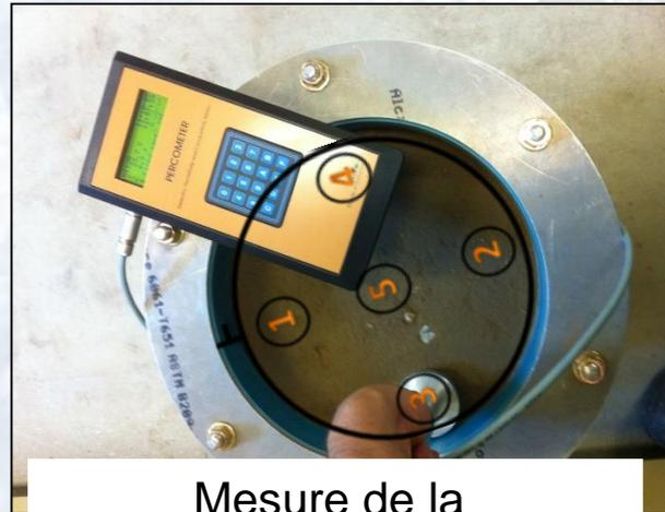
Mesure de la constante diélectrique (DV) Avec percomètre
