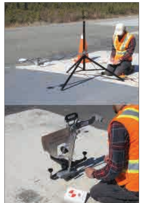
Figure 2 : Mesure de l'albédo (haut) et de la glissance (bas), Beaver Creek, Yukon, mai 2013
