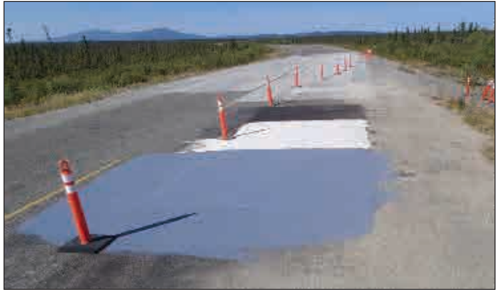
Figure 1 : Site expérimental de Beaver Creek. Du bas vers le haut: Nippo, Lafrentz, enrobé de correction à froid et traitement de surface à granulats clairs
