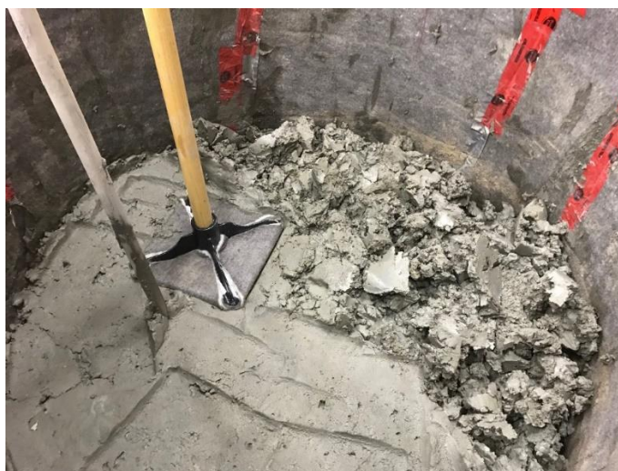
Figure 30 : Densification de la cuve de sol S3 avec le pilon en bois
