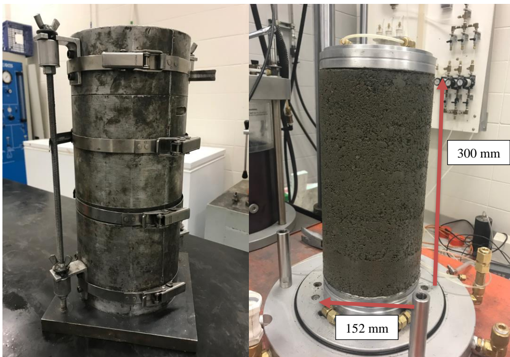
Figure 35 : a) Moule utilisé pour la compaction des échantillons et b) échantillon de sol s3 après compaction
